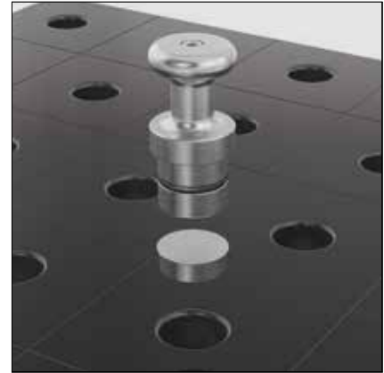
Kép: Az acél védőburkolat eltávolítása mágneses rögzítőcsavarral
