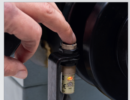
Näherungsschalter bestimmt den Anfang des Programmes
