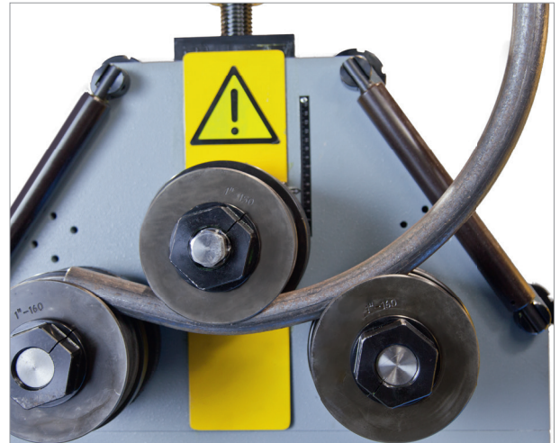
Biegen von Rohr 33,7 mm
