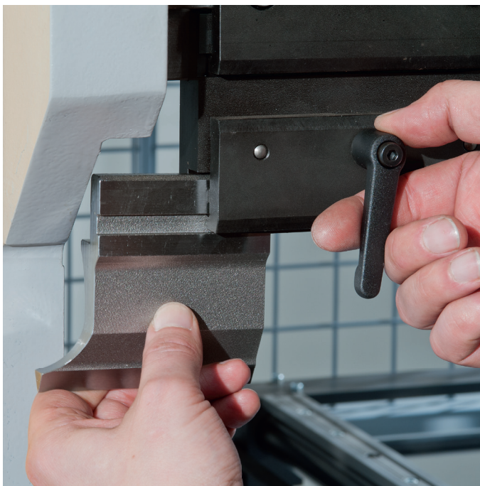
Stempel kann zur Seite entfernt werden
