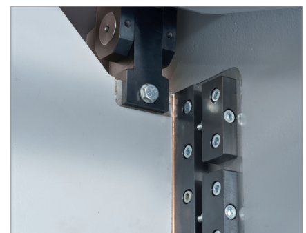
Einfache nachstellbare Führung
