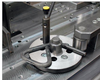
Drehteller zum Aufwickeln
