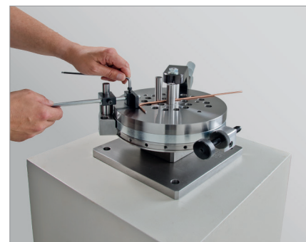
Einstellung für kurze Teile
