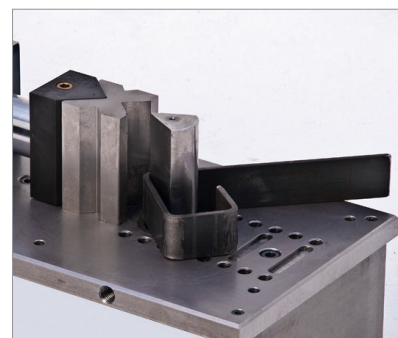
Enges Biegen um den Biegedorn
