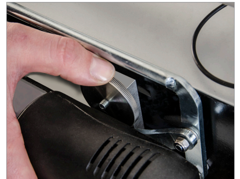
Einstellung der Bandrichtung
