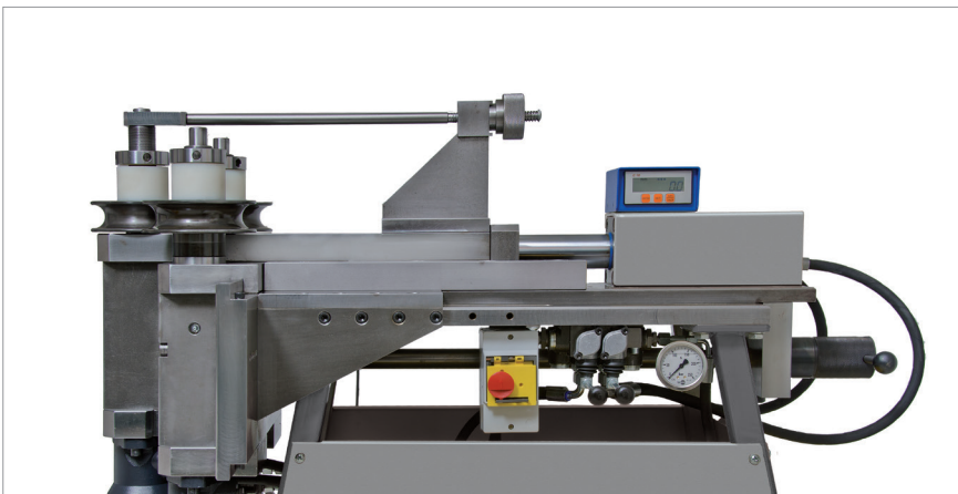
3 angetriebene Wellen, An-/Aussschalter, Handhebel, Manometer, Digitalanzeige, Anschlagleistung
