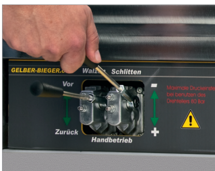
Handhebel für genaues Biegen
